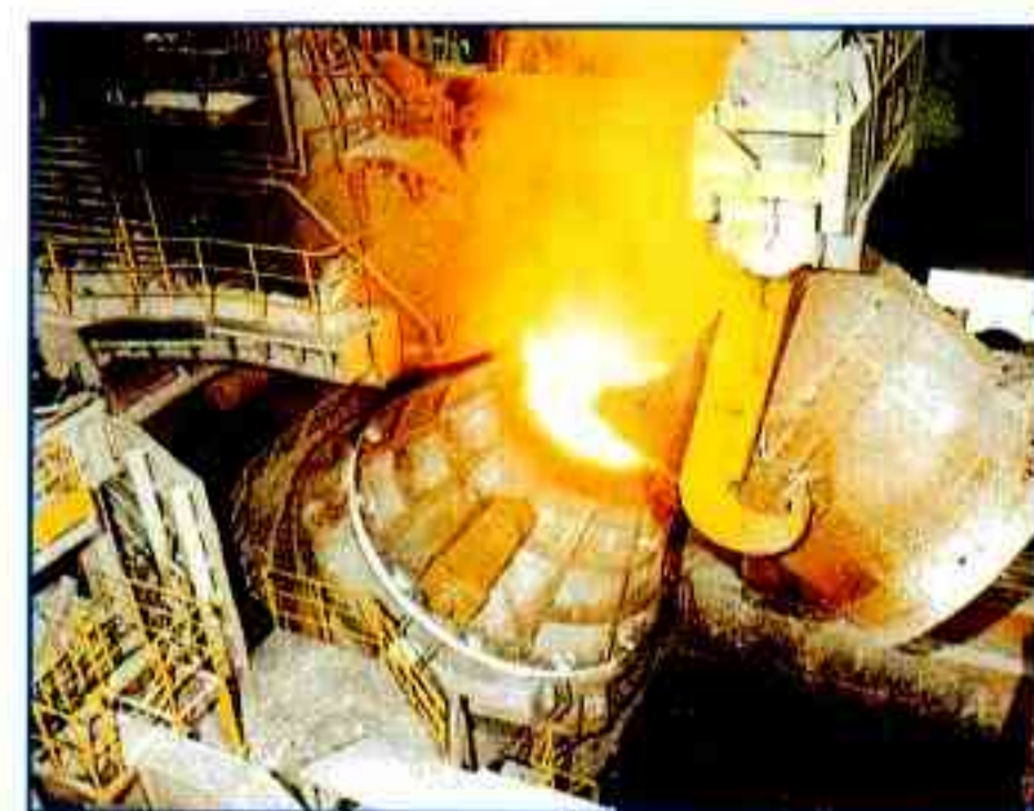
アルゴン酸素精錬炉/Argon oxygen decarburization furnace
