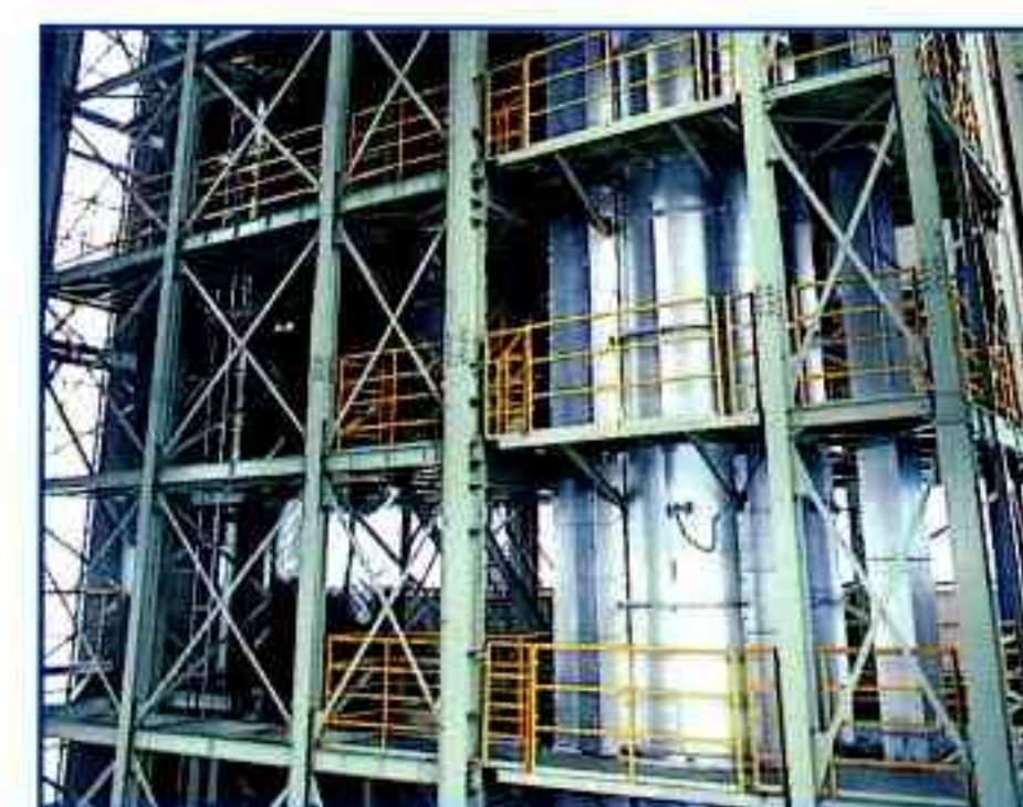
光輝焼鈍ライン/Bright annealing furnace
